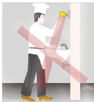
Sl. 7. Istovremeni dodir tijela pod naponom i npr. vodovodne metalne cijevi stvara se opasnost strujnog udara. Pri zamjeni žarulje ili otvaranje električnih uređaja, treba najprije isključiti napon. Električna trošila i uređaji moraju se redovito održavati, a u periodičkim razmacima pregledavati i ispitivati od kvalificirane osobe.
